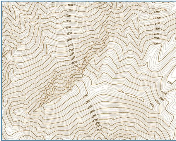
P. CILÍNDRICA ORTOGONAL (PLANO ACOTADO)
